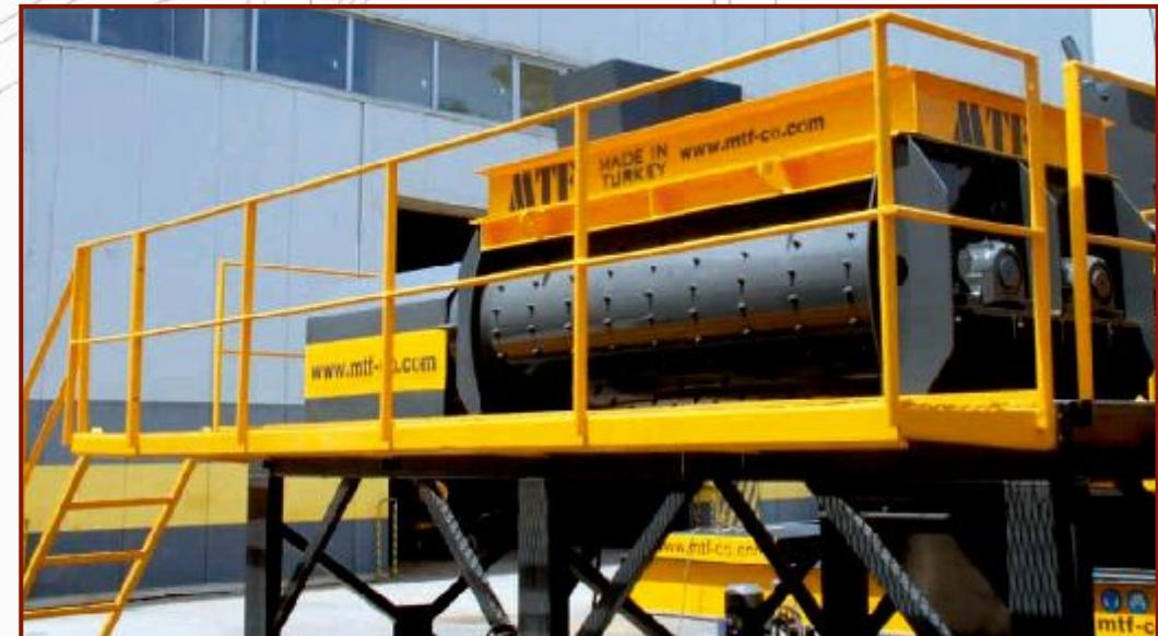
Bu tesislerde, istenilen reçeteeye göre agregat, çimento, su ve katkı maddesi miktarları programlandıktan sonra, agreganın silodan alınıp tartılması, agreganın mikserle yüklenmesi, su ve çimentonun dozajlanması, karıştırma ve mikser boşaltma işlemleri otomatik olarak yapılır.
